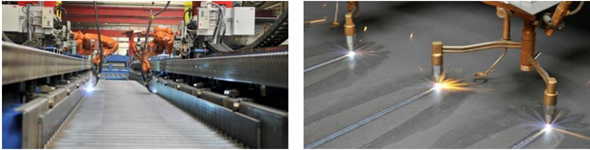
Bilder: automatisierte robotergestützte Produktionslinie für SIN-Wellstegträger im Werk der Zekon
